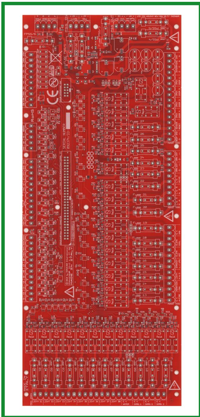
La scheda I/O viene fornita nel KIT **DOMUS360®**. La scheda I/O contiene tutti i relé, fusibili e connettori serigrafati dove vengono effettuati tutti i collegamenti dell'impianto di domotica con i seguenti vantaggi:
