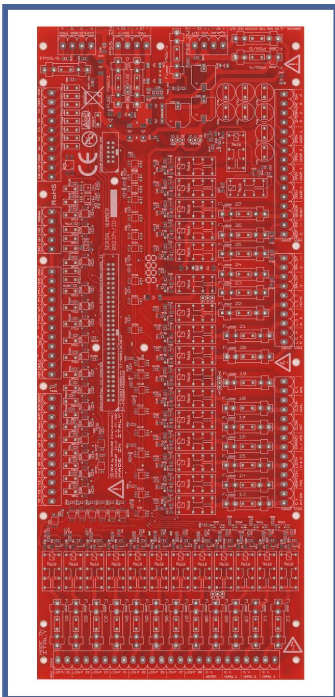
La scheda I/O viene fornita nel KIT **YACHT360**<sup>®</sup>. La scheda I/O contiene tutti i relé, fusibili e connettori serigrafati dove vengono effettuati tutti i collegamenti dell'impianto di domotica con i seguenti vantaggi:
